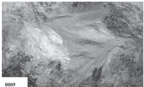
*Рис. 8.* Пластинчато-спиновидный агрегат эвдидимита. Фото шл. 5505-1, николи X
